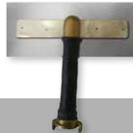
Cette spatule alimentée permet d'appliquer parfaitement les matériaux, de façon continue et automatisée. Ce processus rend le traitement plus rapide.
