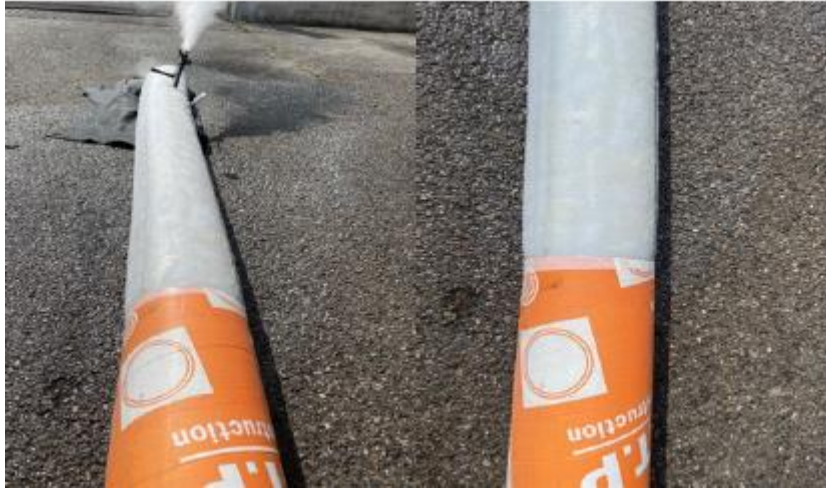
Figure 5 – Exemple de système de calibration pour prélèvement d'échantillons sur chantier
